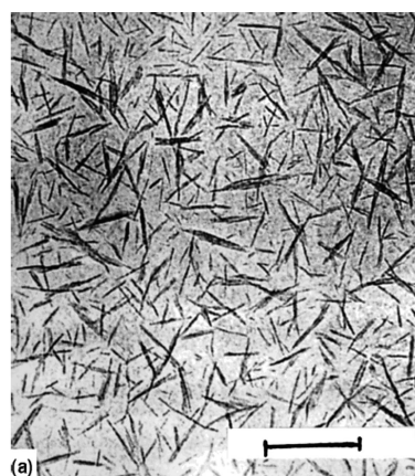
图3 微晶纤维素 TEM 图 [24]
